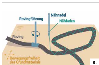
Abb. 2a–c Prozess des Tailored Fiber Placement (TFP): a) Prinzipskizze; b) reale Preformfertigung; c) industrielle TFP-Anlage mit mehreren Legeköpfen (Bildquelle: Hightex Verstärkungsstrukturen GmbH).
