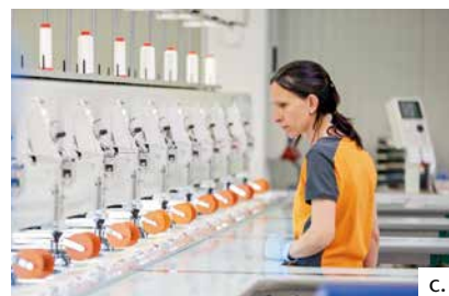
Abb. 2a–c Prozess des Tailored Fiber Placement (TFP): a) Prinzipskizze; b) reale Preformfertigung; c) industrielle TFP-Anlage mit mehreren Legeköpfen (Bildquelle: Hightex Verstärkungsstrukturen GmbH).
