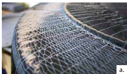
Abb. 1a–c Anwendungsbeispiele des Tailored-Fiber-Placement-Verfahrens: a) Fensterrahmen des Airbus A350 (Bildquelle: Hightex Verstärkungsstrukturen GmbH); b) Leichtbaubogen „rec°16“; c) Leichtbauhocker „L1“.
