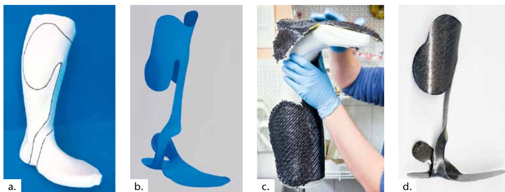
Abb. 5a-d Orthese mit komplexer Geometrie – vom digitalisierten Gipsmodell zum fertigen Bauteil.
